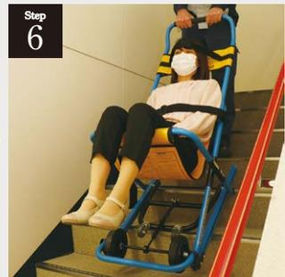
本体下のスキー部に専用ベルトが装着されており、この部分が階段2～3段の角に接地。適度なブレーキがかけられながら楽に階段を降下できます。乗り心地もなめらか。
