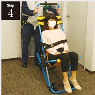
平行移動は、左右のフレームを持ちながら車いすのように押します。回転もその場で容易にできます。この状態で階段の踊り場まで進みます。
