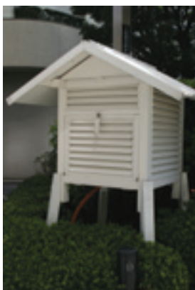
百葉箱の中には、 自動で温度と湿度を計り、 送信する装置が入っています。
